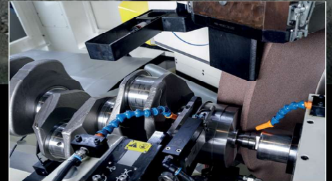
Numerika GH 1500 Korindon Taşlama Makinesi ile Krank Mili Taşlama
